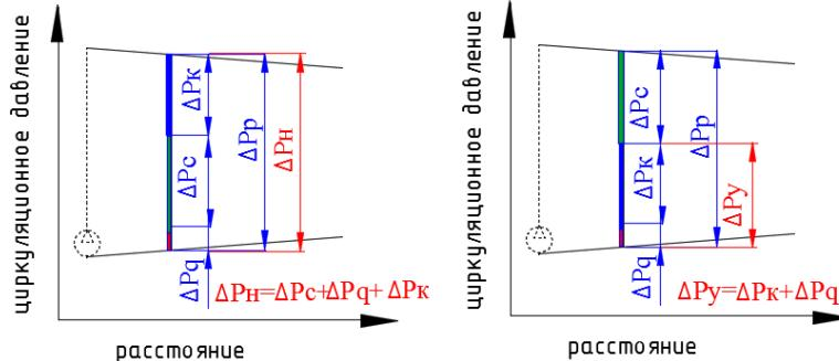
Импульсная трубка подключается на вход балансировочного клапана, установленного на подающем стояке. Схема применяется в случаях, когда арматура предварительной настройки на радиаторах отсутствует.
