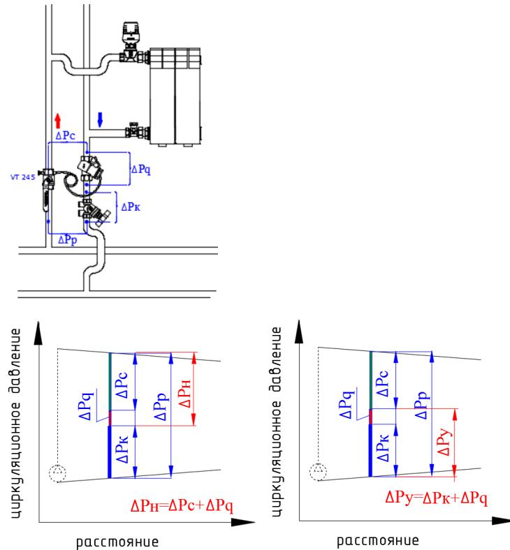
Импульсная трубка подключается к шаровому крану VT.245, установленному на подающем стояке. Балансировочный клапан размещается на обратном стояке после регулировочного клапана. Схема применяется в случаях, когда радиаторы снабжены терmostатическими клапанами с преднастройкой, или, когда на выходе из радиаторов установлены настроочные клапаны. Повышенное (по сравнению со схемами 1 и 2) давление в радиаторах снижает вероятность завоздушивания.
