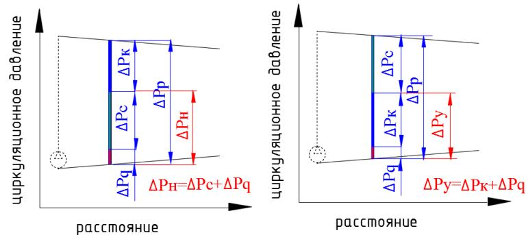
Импульсная трубка подключается на выход балансировочного клапана, установленного на подающем стояке. Схема применяется в случаях, когда радиаторы снабжены терmostатическими клапанами с преднастройкой, или когда на выходе из радиаторов установлены настроечные клапаны.
