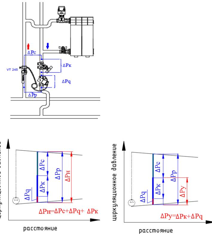
Импульсная трубка подключается к шаровому крану VT.245, установленному на подающем стояке. Балансировочный клапан размещается на обратном стояке до регулировочного клапана. Схема применяется в случаях, когда арматура предварительной настройки на радиаторах отсутствует. Повышенное (по сравнению со схемами 1 и 2) давление в радиаторах снижает вероятность завоздушивания.
