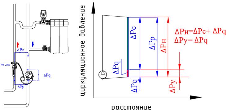
Импульсная трубка подключается к шаровому крану VT.245, установленному на подающем стояке. Схема применяется для стояков, в которых не требуется создание дополнительного увязочного гидравлического сопротивления. Как правило, это либо крайние, либо наиболее нагруженные стояки системы.
